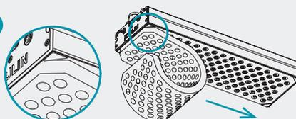
Schaumstoffmatte an den Ecken der Magnetplatte positionieren und vollständig ausrollen.
