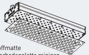
Alte Schaumstoffmatte entfernen. Greiferbodenplatte reinigen. Schutzfolie von der Klebseite der Magnetplatte abziehen und Magnet auf die Unterseite kleben.
