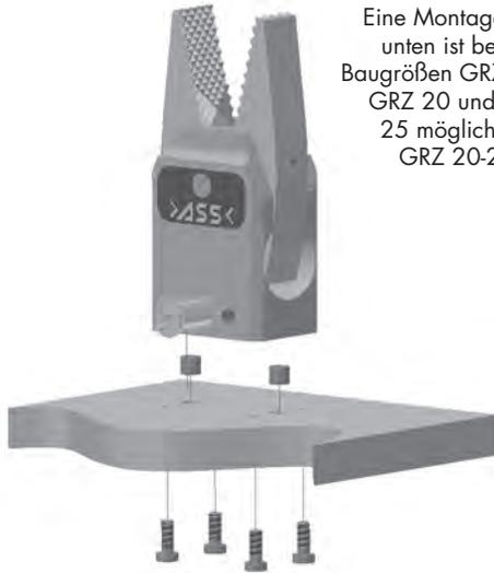
Eine Montage von unten ist bei den Baugrößen GRZ 14, GRZ 20 und GRZ 25 möglich (hier GRZ 20-20 R).
