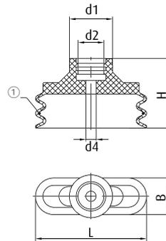
① = Drahtbügelverstärkung verhindert Einknicken des Saugers
