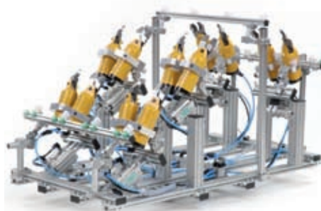
Schneidstation zum automatischen Abtrennen von Angüssen.
