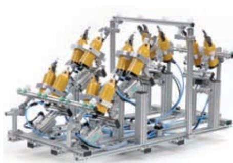
Schneidstation zum automatischen Abtrennen von Angüssen.
